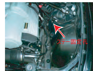
12: アダプターにジョイントアダプターを取り付けます。ラバー付きスタッドボルトを取り付けます。予めラバーホースも取り付けおきます。
