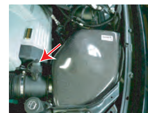
18: エアフロメーターのカブラーを元の通りに取り付けます。
