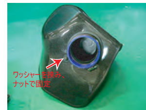
13: アダプターにフィルターを取り付けて、フィルターケース内に入れます。ラバーホース、スタッドボルトを孔から出してワッシャーを挟み、ナットで固定します。
