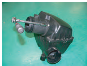
2: ノーマルクリーナーケースからエアフロメーターを取り外します。
