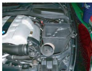
1: エアフロセンサーのカブラーを外します。ボルト2箇所を外し、ノーマルクリーナーケースを取り外します。
