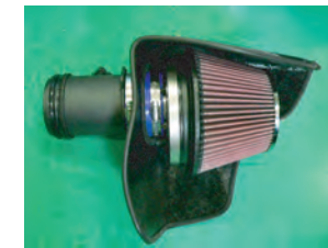
14: ラバーホースにエアフロメーターを取り付けます。
