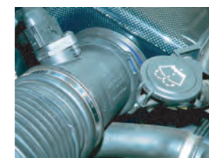
17: エアフロメーターをノーマルインテークホースに取り付けます。
