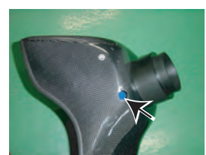
11: グロメットを外し、サービスホールからドライバーを入れてホースバンドを締め付け、固定します。ラバーホースとエアフロは互いに押し付け、フィルターケースと密着させた状態でバンドで締めます。固定後は元の通り、グロメットで塞いでください。
