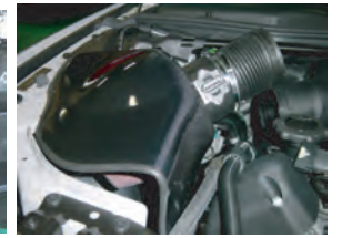
15: 右側はノーマルのホースをエアフロアダプターに取り付け、ケースASSYを斜めから配置し、ホースを目一杯縮めてパイプに差し込みます。
