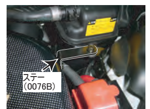
18: 左側のダクトをビスBで固定します。ウォッシャー液の補充にはダクトの着脱が必要になりますので、装着前にウォッシャー液の量をご確認ください。
