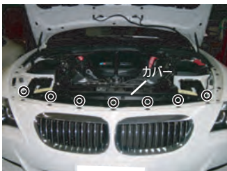
4: バンパーを取り外します。ラジエター上部のカバーを外し、○印のボルトを外し、バンパーを取り外します。(トルクスボルト7ヶ所)
