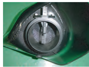
10: エアフロアダプター、整流ハニカムとラバーホースの間にフィルターケースを挟み組み付けます。ハニカムは金属メッシュがエンジン側です。
