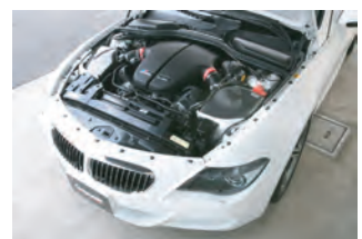
19: エアフロセンサーのカプラーを取り付けます。バンパーを元の通り戻します。
