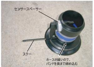
アダプターにステーを取り付けます。(整流ハニカムと共締め) エアフロアダプターにセンサースペーサーをはさみ、エアフロ センサーを付属ビスで取り付けます。
