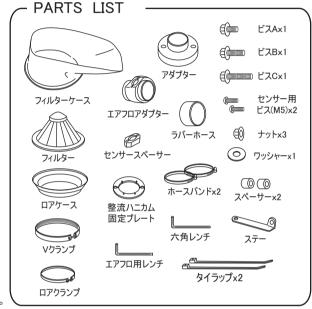
フィルターケース、フィルター、ロアケース、Vクランプ、ロアクランプ、アダプターは予めセットされて包装されています。
