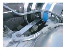
ノーマルケース固定クリップを外した孔に ステーを取り付けます。 (ビスAとワッシャー、ナットを使用)
