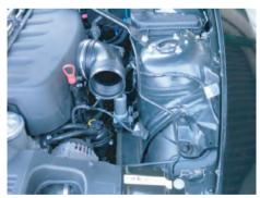
エアフロメーターのカプラーを外し、ノーマル クリーナーケースを上に引き上げて外します。
