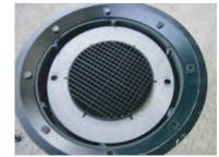
整流ハニカム固定プレートをかぶせてスペーサーを 挟み、ビスBとCで固定します。 (ステーと共締めするほうは、ビスC使用)
