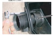
ノーマルクリーナーケースから整流ハニカムを取り外します。 エアフロセンサーも付属レンチで取り外します。
