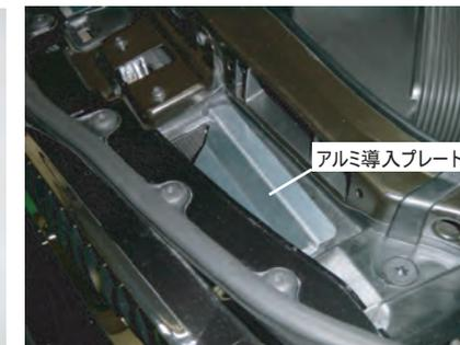
5: アルミ導入ダクトを左右それぞれ、両面テープで貼り付けます。ノーマルの導入ダクトAを挟みこむようにして元の通りに取り付けます。
