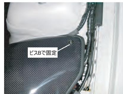
4: ノーマル導入ダクトBとダクトケースを接続させます。フィルターケースをボディにビスBで取り付けます。
