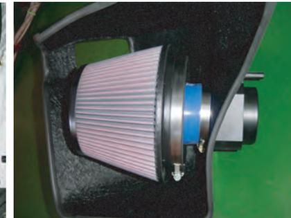
2: 上のイラストを参照し、ラバーホースとエアフロアダプターの間にはフィルターケースを挟むように組み付けます。同時にフィルターも取り付けます。
