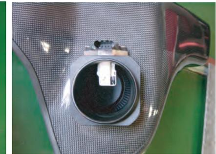
3: エアフロセンサーのカブラーの位置を上に向けます。そのままエンジンルームに配置し、エアフロアダプターをノーマルのインテークホースに取り付けます。
