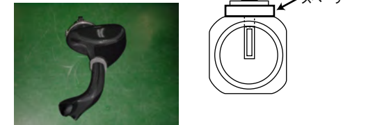
3: エアフロアダプターにセンサーを取り付けます。その時Spacerをはさみ、付属ビスで取り付けます。
