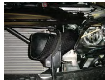
7: 導入ダクトをフィルターケースに差し込みます。
