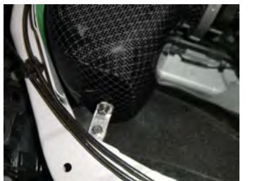
6: フィルターケースをステーで固定します。(付属ステー、ビスAx2本を使用)
