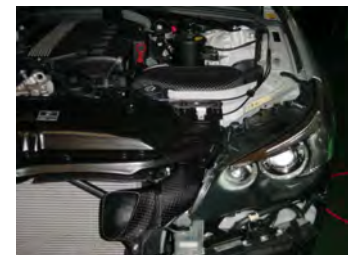
8: 導入ダクトをボルトで固定します。(ビスAx1本を使用)
