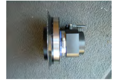
3: エアフロアダプターにセンサーを取り付けます。その時Spacerをはさみ、付属ビスで取り付けます。
