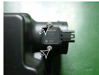
2: エアフロセンサーを付属 レンチでネジを緩めて取り外します。
