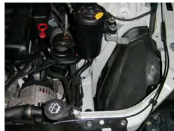
1: ノーマルクリーナーケースをエアフロメーターごと取り外します。
