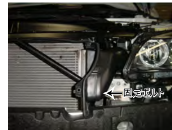
4: ノーマル導入ダクトの固定ボルトを外します。
