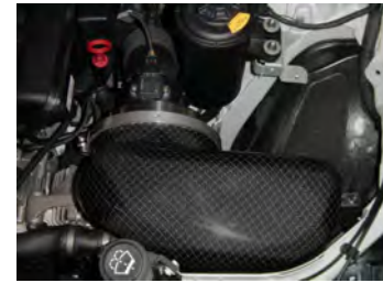
5: インテークホースに取付け、エアフロセンサーのカバーを元の通り取り付けます。
