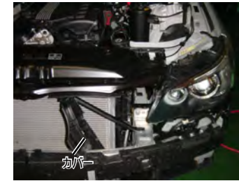
5: カバーを外し、導入ダクトを取り外します。
