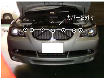
3: バンパーを取り外します。 ラジエター上部のカバーを外し、○印のボルトを外し、バンパーを取り外します。 (トルクスボルト7ヶ所)
