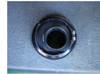
2: ラバーホースでエアフロアダプターも組み付けます。
