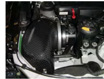
4: 先にフィルターケースとフィルターをエンジンルーム内に配置し、次にアダプターASSYを入れて組み立てます。
