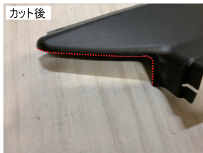
取り外した導入パネルを上記写真の赤点線位置をカットします。(カットは推奨であり、必須ではありません。)
