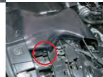
カーボン導入ダクトをステーで固定できる位置に微調整をして、ステーのボディ側ボルトを本締めします。
