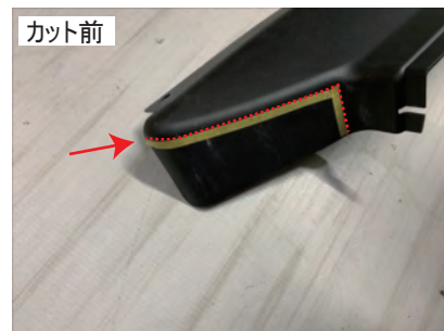
取り外した導入パネルを上記写真の赤点線位置をカットします。(カットは推奨であり、必須ではありません。)
