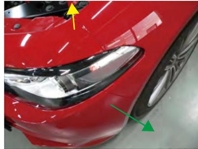
黄色の矢印部は車両に対してライナー内側のツメを押しながら上方向に持ち上げる様に外します。緑の矢印部は車両に対して横方向に広げるように外します。
