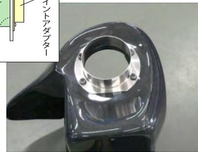
ジョイントアダプターとファンネルアダプターをビスAでカーボンケースに取り付けます。
