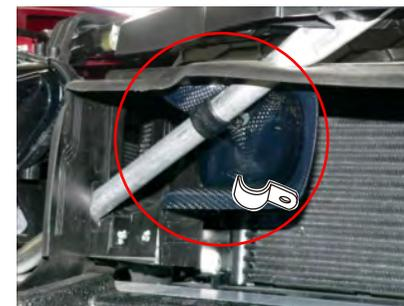
バンパー内のサポートバーに導入ダクトを固定ブラケットを使用してビスDとM4ナットで固定します。
