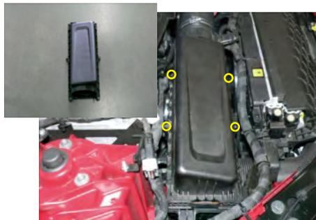
ボルトを 4本外してボックス上部を取り外します。
