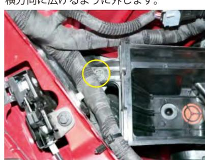
ボックス下部を固定しているボルトを取り外します。
