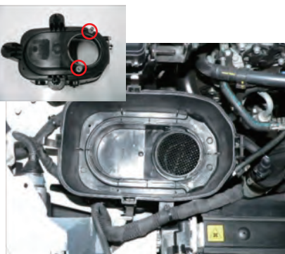
ボルト2本を外し、エアボックス下部を取り出します。(左右)
