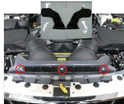
ビスを3箇所外します。エアボックスカバーごと導入ダクトを外します。
