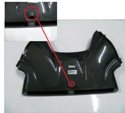
外したクリップナットをカーボン導入ダクトに取り付けます。
