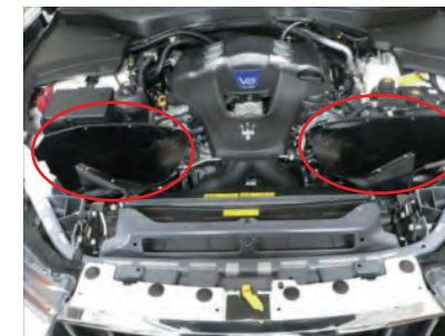
カーボンケースに取り付けたアルミスタッドを車輛のゴム部に挿し、カーボンケースを車輛に取り付けます。
