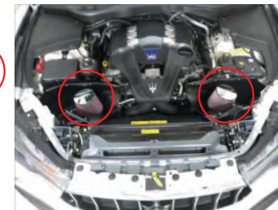
フィルターを取り付けます。
