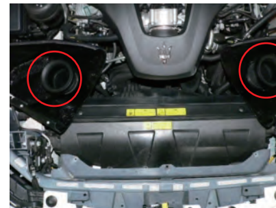
組み立てたアダプターをエアフロメーターに取り付け、バンドで固定します。
