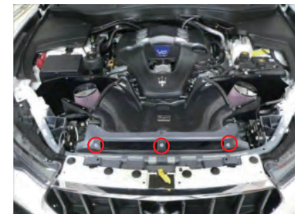
カーボン導入ダクトを車輛に配置し、純正ボルトで取り付けます。締めすぎるとカーボン導入ダクトが浮き上がってしまうので注意してください。
