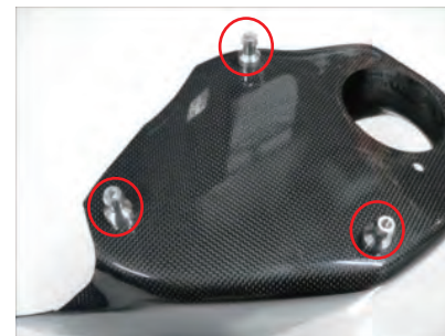
左右のカーボンケースにアルミスタッドをビスAで組み付けます。
