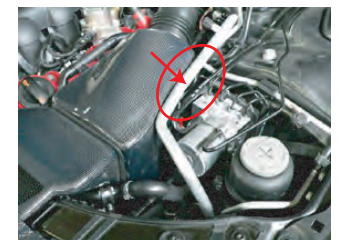
アルミ管とカーボンボックスの間に、クッションテープを貼り付けます。
