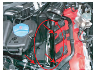
矢印部のネジを外し、クリーナに刺さるように固定されています。ボックスの固定ブラケットを取り外します。
