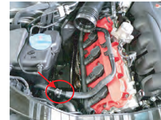
ホースクランプはカーボンボックスの取り付け時に、干渉するので取り外すか、下向きにします。
