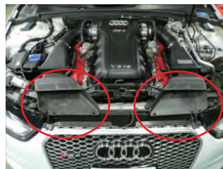
ノーマルの導入ダクトを左右を取り外します。
