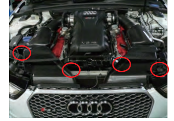
導入ダクトをボックスに差し込み、配置してステーで固定します。
