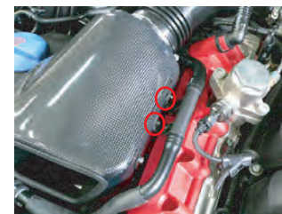
ホース固定ブラケットが干渉する所にクッションテープをカットして貼り付けます。
