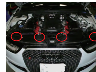
カーボンフロントカバーをノーマルのクリップで取り付けます。
