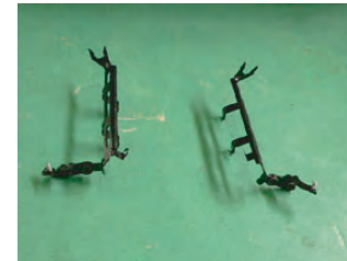
クリーナーボックスの固定ブラケットを左右とも取り外します。
