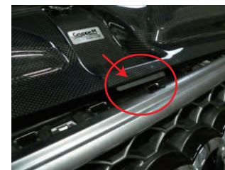
カーボンフロントカバーのツメをグリルに引っかけて配置します。
