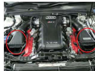
左右のクリーナーボックスを取り外します。
