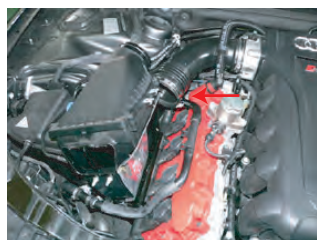
バンドを緩めて、ボックスの奥側を上方に引き上げて取り外します。
