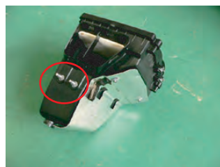
ボックス手前側は、ブラケットのU部に刺さるように固定されています。
