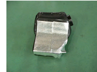
耐熱マットテープを貼り付けたら、ネジ部やカバーの合わせ部はカッターで切り込みを入れておきます。
