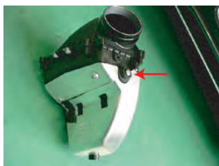
ボックス奥側は、ブラケットのU部に乗っかるように固定されています。
