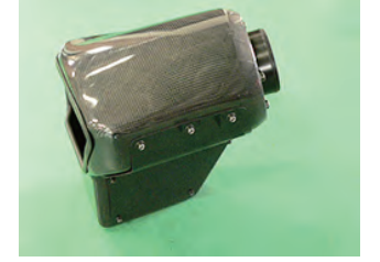
フィルターボックスのボルトを増し締めします。
