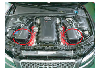
カーボンボックスをエンジンに配置して、サクシジョンホースはカッターで切り込みを入れて差し込み、バンドで締めます。
