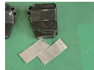
カバー部、底部に耐熱マットテープを貼り付けます。(片側に2枚使用)
