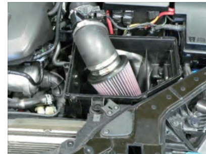
フィルターASSYを車輻に仮置きしてエルボウホースの角度を把握します。フィルターとボックス下部が干渉する場所にクッションテープを張付けます。
