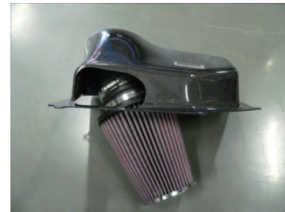
エアフロアダプターにエルボウホース、フィルターを取付けます。
