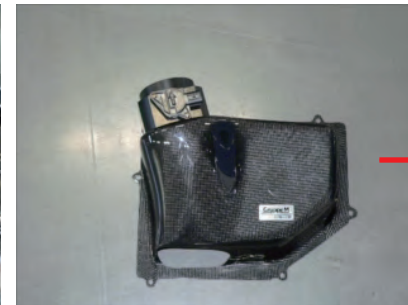
エルボウホースのバンドを緩めてエアフロアダプターを一度外して、アダプターをカーボンケースに取付ます。(ビスB使用)
