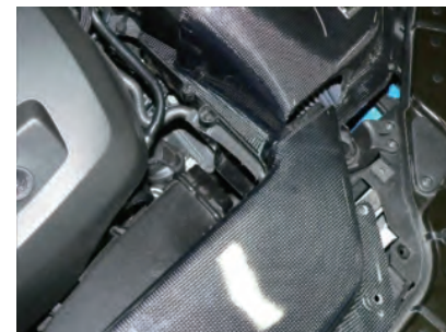
車輻に導入ダクトを取付けます。先端部が引っ掛かるので、上下に揺らしながら配置します。
