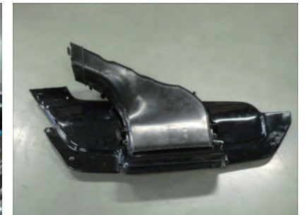
カーボン導入ダクトに純正導入ダクトをはめ込みます。
