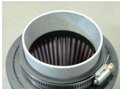
フィルターにアルミパイプを挿します。
