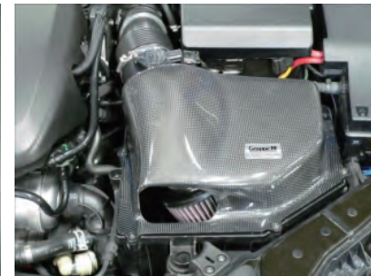
フィルターASSYを車輻に配置します。フィルターが干渉して配置できない場合は、エルボウホースを回転させて調整してください。
