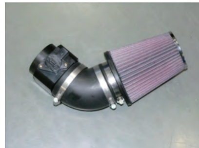
エアフロアダプターとフィルターをエルボウホースで組込みます。
