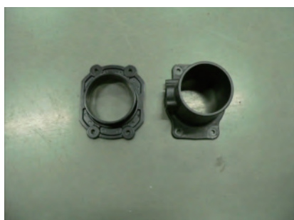
ジョイントアダプターとエアフロセンサーをビスAで取付けます。
