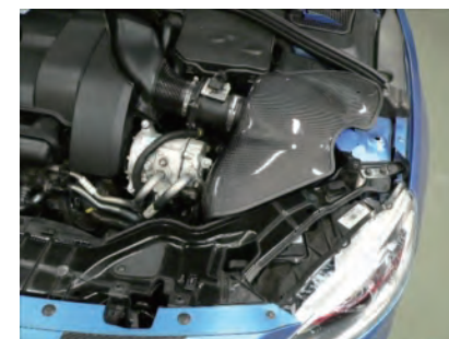
ボックス下部を導入ダクトと一緒に取り出します。
