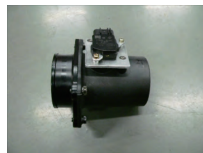
変換プレートを皿ビスで固定します。エアマスセンサーをスペーサーを挟みビスDで固定します。
