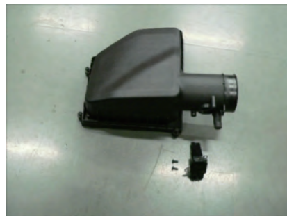
エアマスセンサーを外します。
