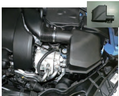
ホースバンドを緩めボックス上部を外します。
