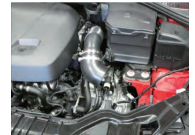
パイプにエルボウホースを取り付けます。
