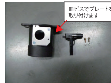
ケースから外したエアマスセンサーをエアフロアダプターに取り付けます。(付属M4ビスとM4スペーサー使用)
