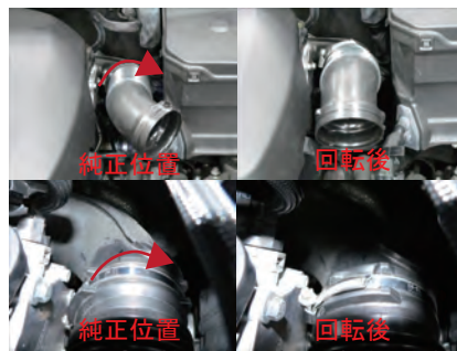
サクシオンパイプを写真の様に回転させます。
