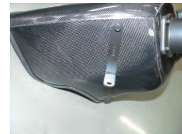
フィルターケースにステー(0183)を仮組みします。(ビスA使用)
