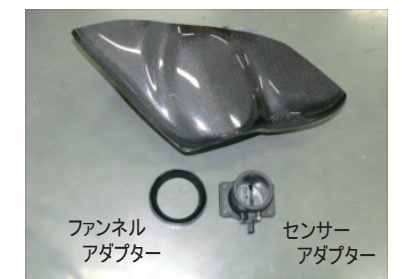
フィルターケースの内側からファンネルアダプターを入れて、外側からエアフロアダプターを取り付けます。(ビスA使用)
