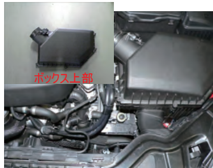
エアクリーナボックスの上部を外します。
