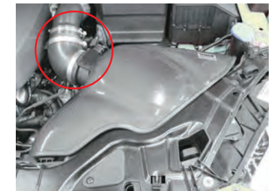
センサーアダプターをエルボウホースに差し込み、フィルターケースASSYを配置します。センサーのカプラーを取り付けます。(配線を付属タイラップで留めます。)
