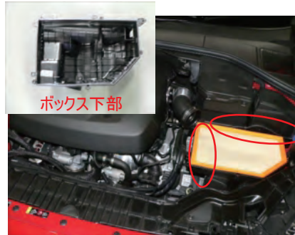
配線留めを外し、ボックス下部を取り出します。
