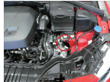
0047ステーをボディに仮止めします。(ビスA、ナット使用)
