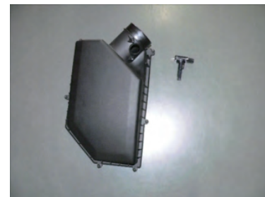
ボックス上部からエアマスセンサーを外します。
