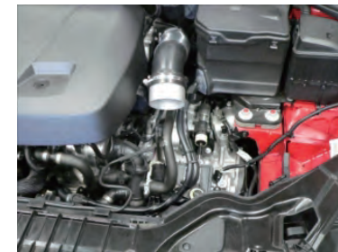
サクシオンホースにアルミパイプを差し込みます。
