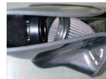
ケース内のアダプターにフィルターを取り付け、バンドで締めます。
