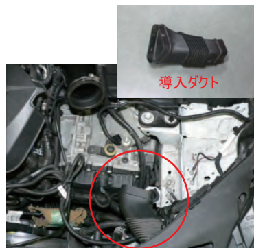
純正の導入ダクトを外します。
