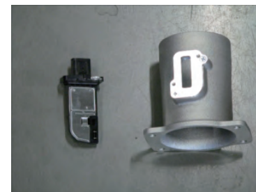
ケースから外したエアフロセンサーをエアフロアダプターに取り付けます。(付属M4ビス・スペーサー使用)
