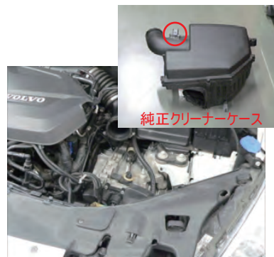
エアフロセンサーのカプラーを外し、クリーナーケースごと全て取り外します。
