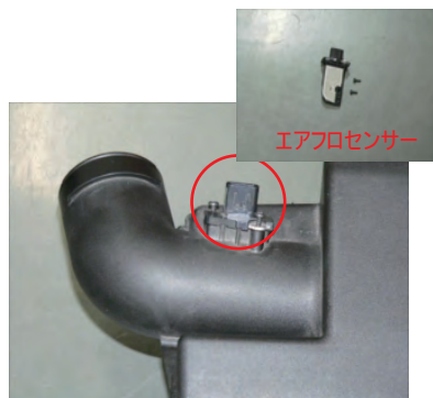
クリーナーケースからエアフロセンサーを取り外します。
