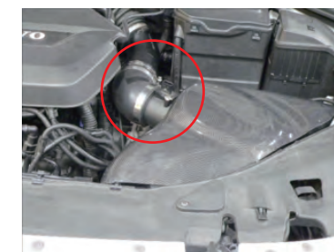
センサーアダプターをエルボウホースに差し込み、フィルターケースASSYを配置します。センサーのカプラーを取り付けます。(配線を付属タイラップで留めます。)
