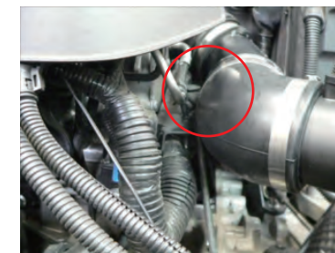
エンジンとエルボウホースのクリアランスに注意しながらステア角度を微調整して固定します。
