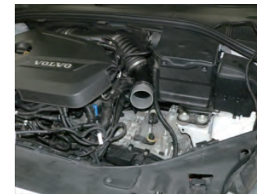
サクシジョンホースにアルミパイプを差し込みます。
