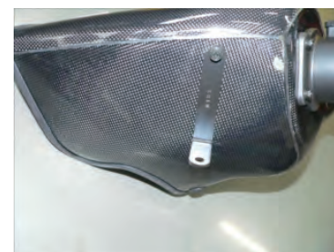
フィルターケースにステア(0183)を仮組みします。(ビスA使用)
