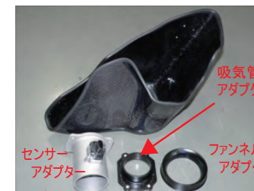
フィルターケースの内側からファンネルアダプターと吸気管延長アダプターを入れて、外側からエアフロアダプターを取り付けます。(ビスB使用)
