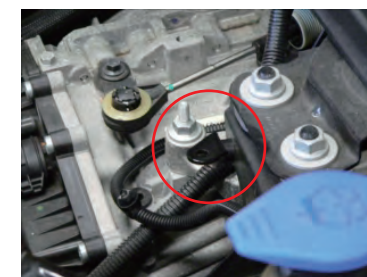
ボディにステア(0047)を取り付けます。(ビスC、ナット、スペーサー使用)
