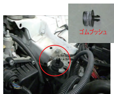
ケースの下側固定用のゴムブッシュを取り外します。
