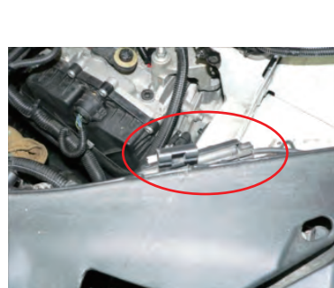
ワイヤーの固定具が上部にある場合は取り外し、裏側に付属タイラップで固定します。
