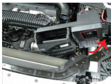
8. BOXを取り出し、フリーにしたユニットとアッパーサポートを元に戻します。
