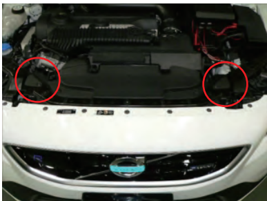
1. ラジエーターアッパーサポートを外します。
