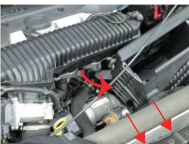
7. ラジエーターが少し動くので車両前方に引きながらBOXを外します。
