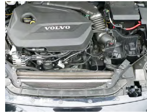
純正の導入ダクトを外した写真。
