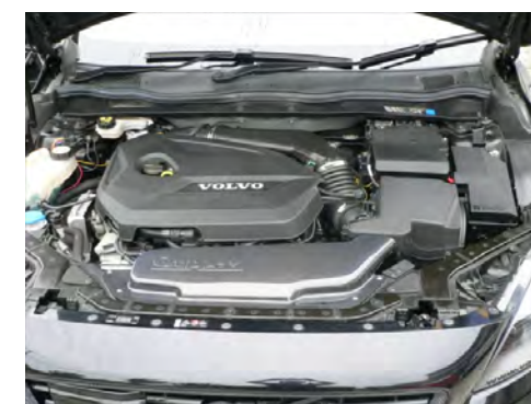
純正のフィルターケース上蓋を元の通りに、取り付けます。
