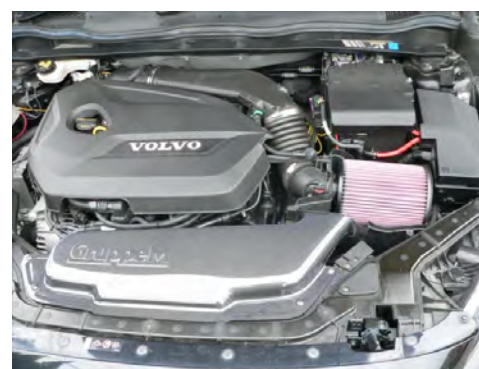
カーボン導入ダクトを取り付けます。(付属ビス使用)
