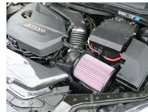
フィルターケースの溝に合わせて、奥までしっかりと装着します。
