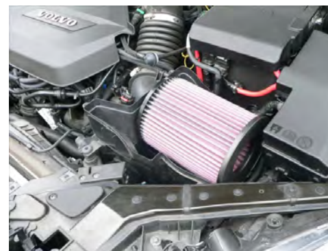
付属のK&Nフィルターを取り付けます。
