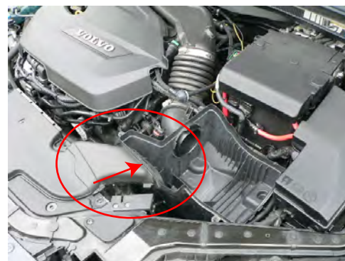
純正の導入ダクトを外します。 接合部の引っ掛かりを外して、ダクトを取り外します。
