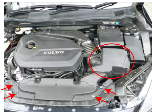
純正のフィルターケース上蓋を取り外します。 純正の導入ダクトの固定ビス4か所も外します。
