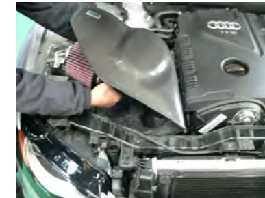
ケースの中に手を入れながらエアマセンサのカプラーを取り付けます。
