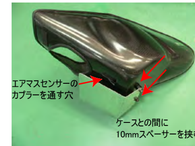
フィルターケースにヒートプレートを取り付けます。10mmスペーサーを挟んでビスB(M6-25mm)で取り付けます。
