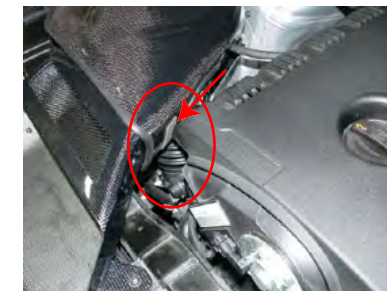
エンジンカバーとのクリアランスが少ないので、半分にカットしたクッションテープを貼り付けます。
