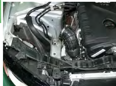
エアマセンサごとノーマルクリーナーボックスを引き上げて外します。(ボルト固定されていません)
