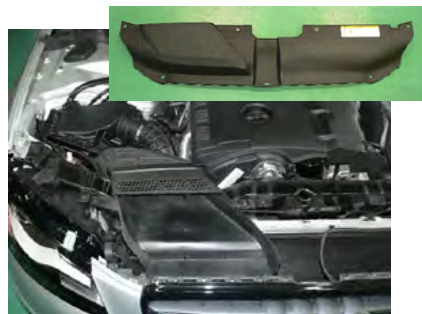
ラジエター上部のパネルを外します。
