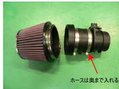
エアマセンサにラバーホース、ファンネルアダプターを取り付けます。 ※ホースは奥まで入れてください
