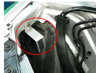
楕円の穴にワッシャー、ビスA(M6-20mm)で裏から入れてステア-Bを取り付けます。
