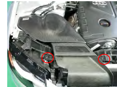
導入ダクトをノーマルビスで取り付けます。ケースとダクトがフィットするように調整します。
