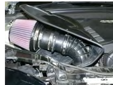
フィルターASSYをサクシオンホースに取り付けます。エアマセンサのカプラー位置は奥側にします。
