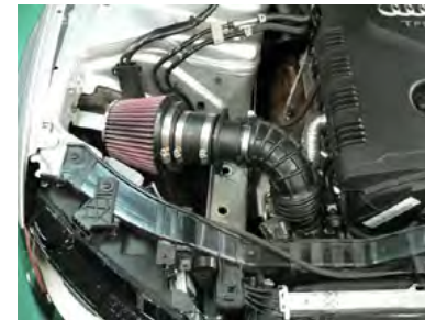
ステア-Bとサクシオンホースの向きを確認する為、フィルターASSYを一度取り付けて調整します。フィルター固定はフィルタートップ部をステア-Bに押し当てて保持させます。
