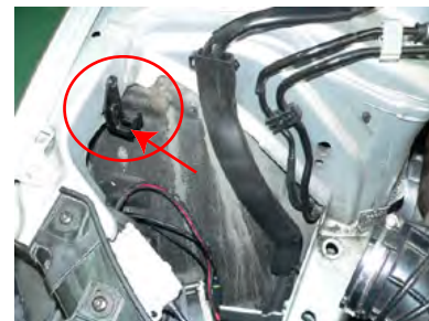
ノーマルクリーナーボックス固定ブラケットを外します
