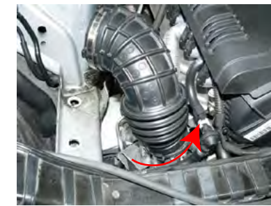
サクシオンホースを左回転に5mm位回転させます。 ※予めサクシオンホース外側に潤滑油などを塗っておくとカーボンケースとの接地面の滑りがよくなり作業性が向上します。
