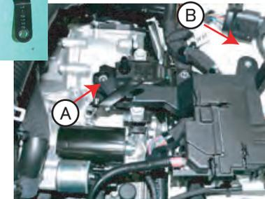
クリーナーボックス下の樹脂ブラケットの矢印Aのナットを外します。この矢印A,B部にステアを取り付けます。
