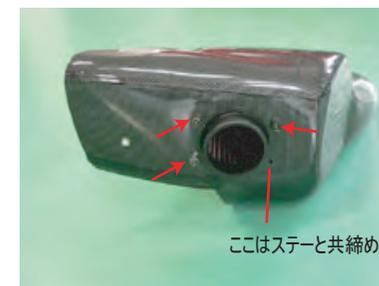
その状態で、フィルターケースに配置してボルトで組み付けます。(ビスAで3箇所)
