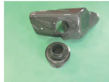
フィルターにファンネルアダプターを取り付けて、その上にジョイントアダプターを乗せます。
