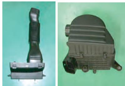
導入ダクトの先端部はトルクスタッピングビスで固定されています。また裏側に留めてある配線も外します。クリーナーボックスは上に引き上げて外します。
