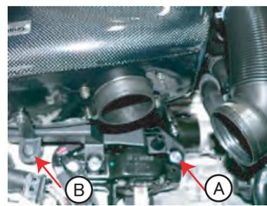
クリーナーASSYを配置して、ステアで固定します。A部は樹脂ブラケットの下にステアを取り付けます。
