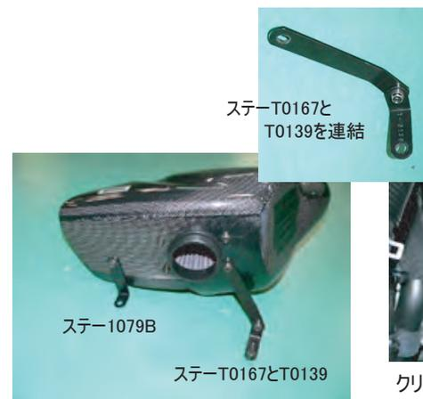
ステアT0167とT0139を連結させて、フィルターケースに仮組みします。ステア1079Bも仮組みします。
