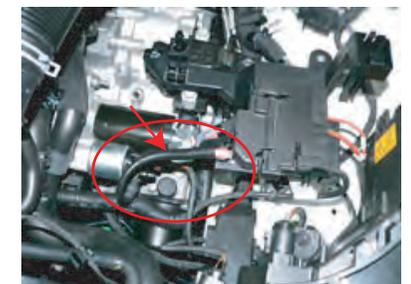
セルモーターの電源コードにコルゲートチューブを被せます。クリーナーケースと干渉するので電源コードを下の方に押し下げてください。破れが無いか定期的に点検してください。
