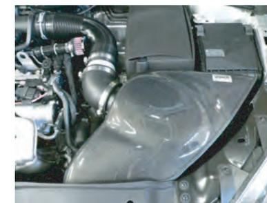
フィルターケースのクリアランスを確認しながら各部、増し締め固定します。
