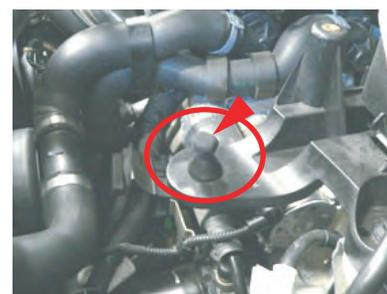
ノーマルケース固定の凸部の先端にフィルターケースが干渉する為、付属クッションテープを半分位にカットして貼り付けます。
