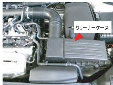
エンジンカバーを外し、ノーマルのクリーナーケースを外します。
