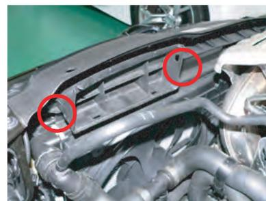
導入ダクトの先端部分を取り外します。(タッピングで固定されています)
