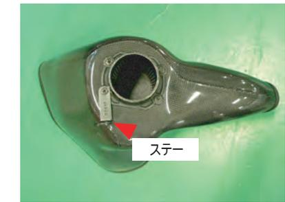
フィルターケースの上からジョイントアダプターを乗せ、ビスAで固定します。1箇所ステアと共締め。
