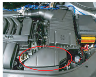
ノーマル導入ダクトを外します。(トルクスタッピングビスで固定されています)
