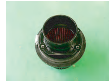
フィルターにファンネルアダプター、ジョイントアダプターを乗せます。
