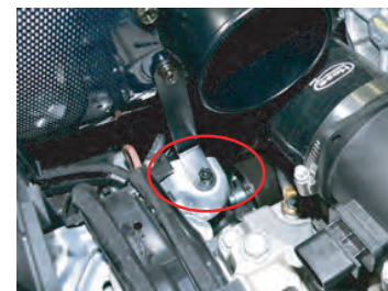
フィルターケースを導入ダクトの入口部分に合わせ、ステアをボディ側に仮組みします。
