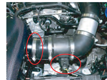
ラバーホースを差し込みます。エアマスセンサーのカプラーを取り付けます。
