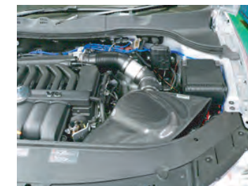
フィルターケースのクリアランスをみながら、ステアを本締めします。
