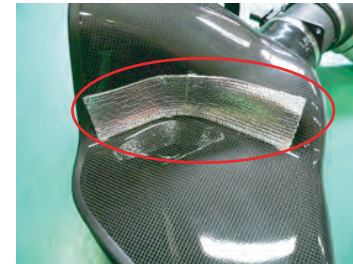
フィルターケース裏面とラジエターホースとの干渉部に耐熱マットを貼り付けます。(写真参照)
