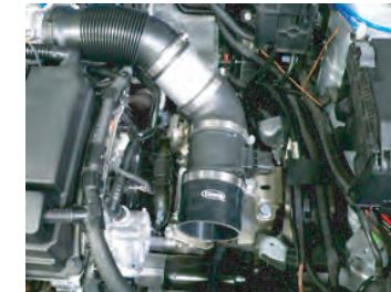
アルミパイプの先に、エアマスセンサーASSYを取り付けます。
