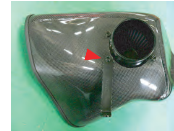
クリーナーASSYをそのままの状態カーボンケース内側から入れて、ビスAで取り付けます。一箇所にステアを取り付けます。
