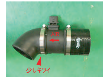
エアマスセンサーにストレートホースとエルボウホースを取り付けます。※向きに注意。
