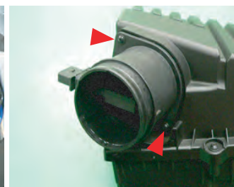
クリーナーケースから矢印部のネジを外し、エアマスセンサーを外します。
