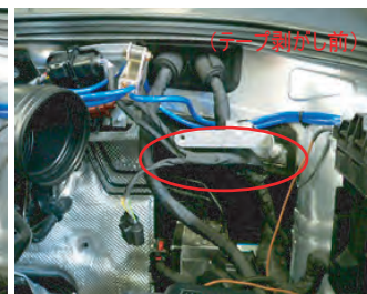
配線を束ねているテープを剥がします。
