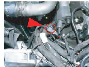
11.クリーナーケース下にある配線ケーブルはカーボンフィルターケースに干渉する為、移動させタイラップで固定します。
