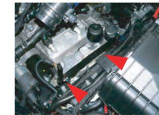
13.補強ステー(0311A)を置き、その上にステー(T0197)を写真のように取り付けます。
