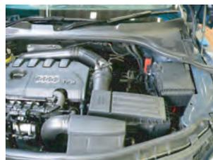
1.導入ダクト、クリーナーケースを取り外します。(各部分は分割して取り外します)
