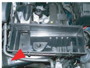
8.ケースの下側を取り外します。場合によってはU型の導入ダクトを分割して外します。
