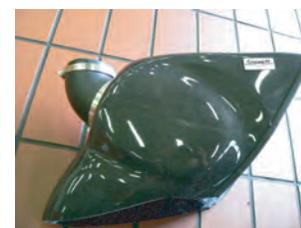
17.フィルターにファンネルアダプターを取り付け、カーボンフィルターケースの内側から入れて、外からビスAで固定します。エルボウホースも取り付けます。
