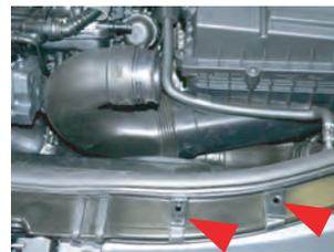
4.トルクスタッピングを外し、下側部分を取り外します。
