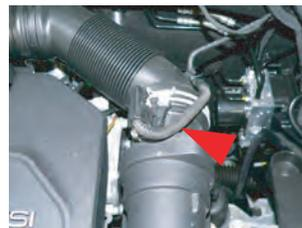
5.エアマスセンサーのカプラーを外し、同時にインテークホースのバンドを取り外します。
