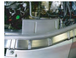
10.導入ダクトの先端部分だけを元の通りに戻します。
