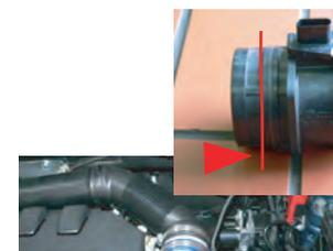
19.カーボンフィルターケースASSYをエアマスセンサーに差し込み、バンドで固定します。この時、差し込み位置は奥まで入れずに写真の赤い線まで入れます。
