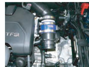
16.アルミパイプに「14」で組み立てたエアマスセンサーを取り付けます。
