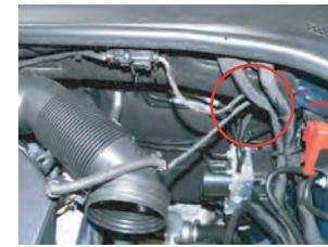
12. エアマスセンサーを手前に移動させる為、配線の通す位置を変更します。
