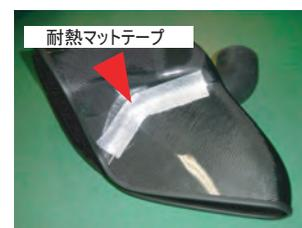
18.カーボンフィルターケース裏側のラジエーターホースに当たる部分に付属の耐熱マットテープを貼り付けます。
