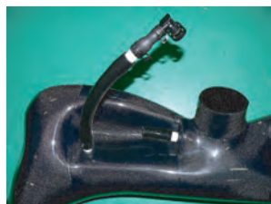
12. 外したホースからL型ニップルを外し、チャンバーケースに付いているホースニップルに差し込みます。
