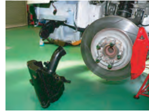
6. エアマスセンサーのカブラーを外し、クリーナーケースを取り外します。
