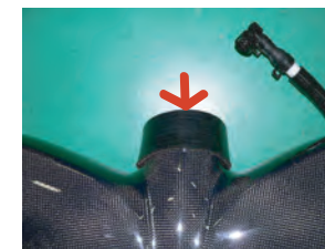
13. チャンバーケースのスロットル側にφ90(L50mm)ホースを奥まで一度差し込み、取り付けます。予めバンド#60は通しておきます。
