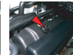
11. エンジンヘッドカバーからブローパイプを取り外します。
