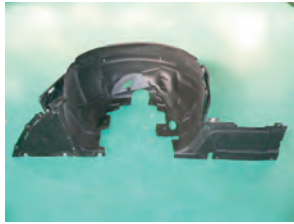
2. アンダーカバー、インナーフェンダーを外し、フロントバンパーを外します。
