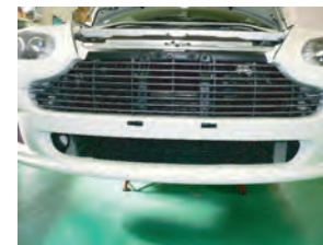
24. バンパーとインナーフェンダー、アンダーカバーを元の通り取り付けます。
