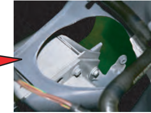
9. 両側のサクションホースが通っていた孔を最大限大きく加工します。赤ライン参照実車によってもとの孔の大きさが左右違うので最大限に大きく加工して下さい。(目安は5~10mm程度)
