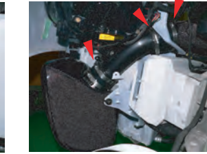
23. 各部クリアランスを見ながらバンドで本締めします。
