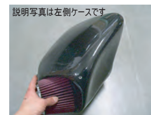
17. 付属アダプターにフィルターを取り付け、フィルターケースに入れてビスAで固定します。左右同じように組み立てます。
