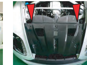
27. 最後に付属のエンジンカバーを取り付けます。
