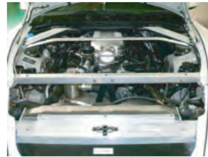
8. サクションホースからブローパイプを引き抜いて外します。
