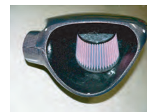
17. 付属アダプターにフィルターを取り付け、フィルターケースに入れてビスAで固定します。左右同じように組み立てます。
