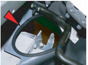
10. 加工した孔に付属のミソゴムを貼り付けます。
