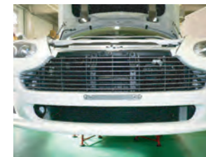
25. 付属のナンバープレートステーを取り付けます。(ノーマルタッピングビスを使用)
