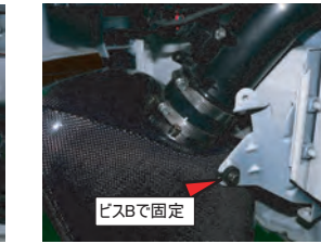
22. フィルターケースをホースに差し込み、ビスBで固定します。
