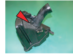
16. ノーマルクリーナーケースからエアマスをセンサーをパイプごと取り外します。
