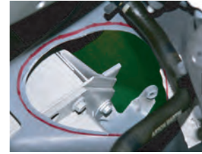
9. 両側のサクションホースが通っていた孔を最大限大きく加工します。赤ライン参照実車によってもとの孔の大きさが左右違うので最大限に大きく加工して下さい。(目安は5~10mm程度)
