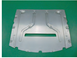
2. アンダーカバー、インナーフェンダーを外し、フロントバンパーを外します。
