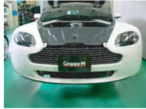
1. ナンバープレート、プレートの土台、フロントグリルを外します。
