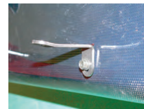
ステー取り付け写真
