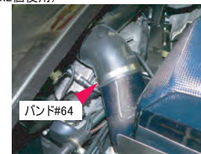
ノーマル導入ダクトとカーボンフィルターケースをノーマルエルボウホースで接続して、付属のバンドで取り付けます。
