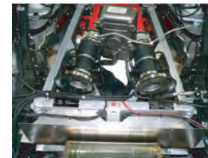
エアフロメーターに取り付け、バンドで締めます。カーボンフィルターケースを取り付ける時に向きを調整します。
