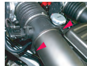
エアフロメーターとノーマルクリーナーボックス間のボルトを外します。
