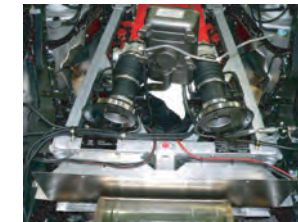
ヒートプレート装着後 (付属タイラップ6本で配線をまとめます)
