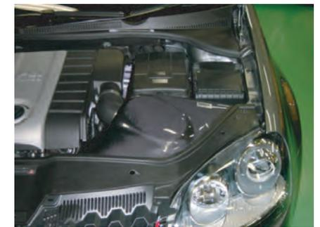
元の通り、ノーマルフィルターケースをエンジン上部に取り付け、エアフロメーターを取り付けます。
