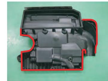
ノーマルフィルターを取り外し、フィルターケース内をきれいに洗浄して、フィルターケースロア側にケース外周用のパッキンテープを貼り付けます。脱脂して赤のラインの所に貼り付けます。
