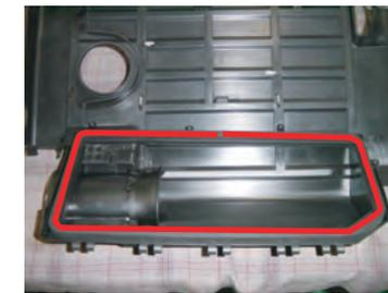
フィルターケースアッパー側にフィルターパッキンテープを貼り付けます。脱脂して赤のラインの所に貼り付けます。ケースを元の通り、上下を合わせビスで取り付けます。
