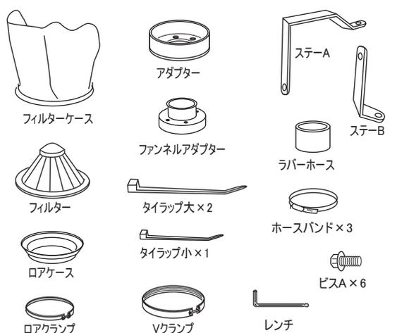
ダクトケース、フィルター、ロアケース、Vクランプ、ロアクランプ、アダプターはクリーナー-ASSYとして組み立てた状態で梱包されています。
