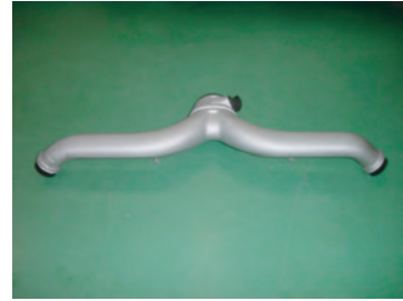
3: インタークーラーパイプのバンド類を緩めて取り外します。
