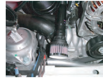
8: エアポンプホースにフィルターを差し込み、9: 導入ダクトを取り付けます。タイラップで締め付けます。ホースが揺れないように残り2本のタイラップで留めます。
