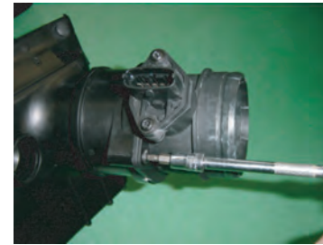
7: ノーマルクリーナーからエアフロメーターを左右それぞれ取り外します。エアフロメーターは元の通り、ノーマルインテークホースへ戻しておきます。
