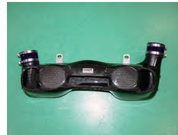
14: フィルターカバーをビスBで取り付け、エンジンルームに配置します。エアフロメーターにホースを差し込み、バンドで固定します。
