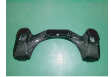
8: エアポンプホースにフィルターを差し込み、9: 導入ダクトを取り付けます。タイラップで締め付けます。ホースが揺れないように残り2本のタイラップで留めます。
