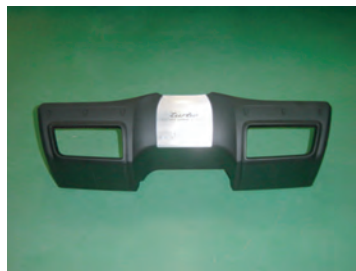
5: ノーマルクリーナーのカバーを取り外します。差し込み式でビス固定はありません。
