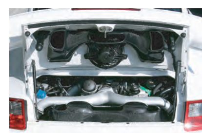
15: インタークーラーパイプを元の通り戻します。フードを閉めたとき上下が上手く合わさるか確認しながら微調整します。その後、各部増し締め固定を行いません。
