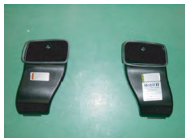
4: ノーマルの導入ダクトを外します。ビス1箇所と両面テープで取り付けがあります。
