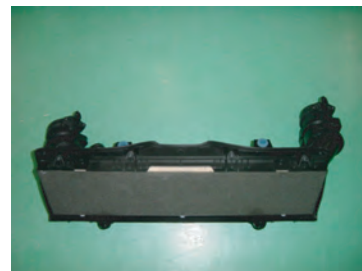
6: エアポンプのホースを抜き取ります。エアフロメーター部のバンドを緩めてノーマルクリーナーASSYをエアフロメーターごと上へ持ち上げて取り外します。
