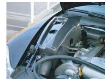
13: ウェザーストリップを外します。カーボンケースとエルボウホースを持った状態で真上から垂直に下に降ろしていきます。ある程度のところエアマスセンサーにエルボウホースを軽く差し込み仮留めします。カーボンケースの一番下がノーマルケース固定ブラケットの内側(エンジン側)になるように配置してください。外側ですとカーボンケースが上手くフィットしません。※手が入りづらいので少しコツが必要です。
