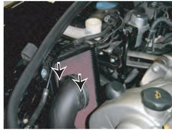
5: フィルターケースのアップパーケースを外します。ケースとインテークホース部の外し方は矢印のピンを半回転させてピンを引き抜きます。
