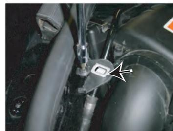
3: エンジンカバー固定用ブラケットを一度外します。(カーボンパネル装着時に元に戻します)
