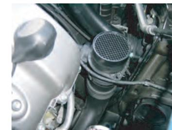
11: エアマスセンサーを元の通りインテークホースに取り付けます。配線カプラーも取り付けます。
