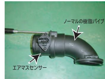
7: インテークホースからエアマスセンサーASSYを外して、ノーマルの樹脂パイプを外します。
