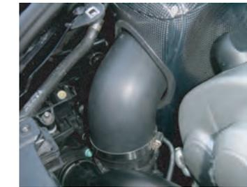
14: 上手く配置ができれば、エルボウホースをエアマスセンサーに約20mm差し込んだ状態でバンドで固定します。(エアマスセンサーには約20mmの所に線が付いています)
