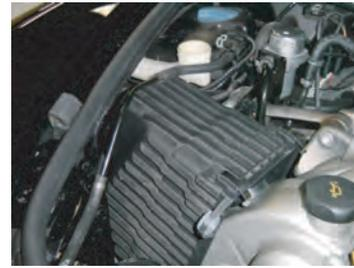
6: クリーナーケースのロアケースを外します。ロアケースは上に引っ張り上げて外します。●左側も同様に外します。
