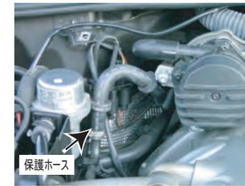
9: エアポンプホースはカーボンケースのナットサートに干渉する恐れがあるため、保護ホースをかぶせます。
