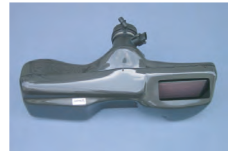
フィルターケースカバーをビスAで8箇所取り付けます。
