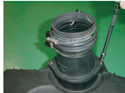
クリーナーケースからエアフロメーターを外します。
