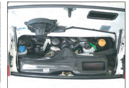
フィルターケース裏側はプーリーとのクリアランスが狭いので十分ご注意ください。
