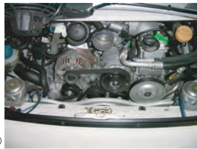
クリーナーケースをエアフロメーター、インテークホースごと取り外します。
