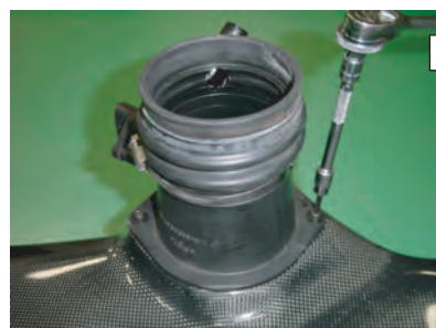
エアフロメーターをカーボンフィルターケースに取り付けます。(ビスBを使用)
