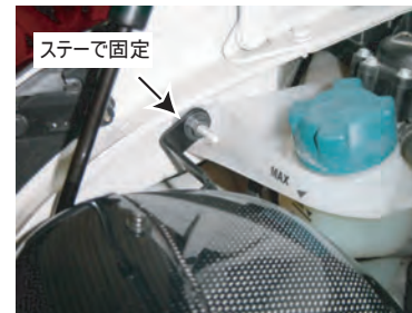
フィルターケースをエンジンルームに配置し、ステーでフィルターケースを固定します。
