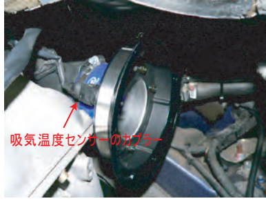
アダプターをラバーホースに差し込み、バンドで固定します。温度センサーを差し込み、カプラーを取り付けます。配線はタイラップ小で留めます。
