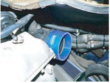
エアマスセンサーを戻し、付属のラバーホースを取り付けて、エアマスセンサーのカプラーを取り付けます。
