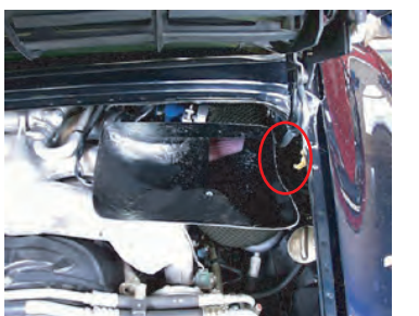
各部クリアランスに注意して、増し締め固定します。
