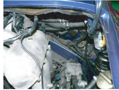
エアマスセンサー部のバンドを緩めてクリーナーケースを外します。(エアマスとケースは分割して外します。)
