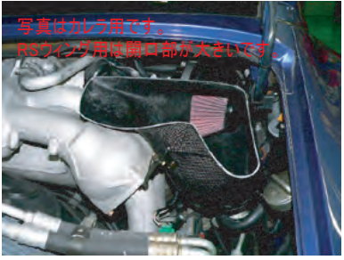
フィルターとフィルターケースを配置し、Vクランプで固定します。アダプターを回転させて、位置を調整します。
