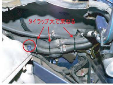
赤丸印にあったホースホルダーを外し、写真のように奥側のホースにタイラップ固定します。
