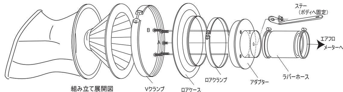
2: 組み立てたアダプターをラバーホースでエアフロメーターに接続しバンドで固定します。
