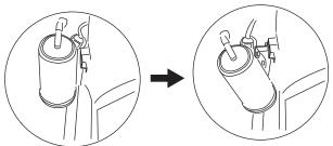
3:組み付けたクリーナーASSYをエアフロメーターへ取り付け、バンドで借り固定します。
