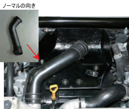
11. サクションホースを 反転 させて取り付けます。(ジャバラがクリーナー側に来るようにします)
