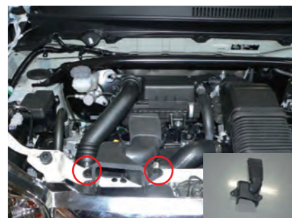
1. クリップを二箇所外し、導入ダクトを取り出します。
