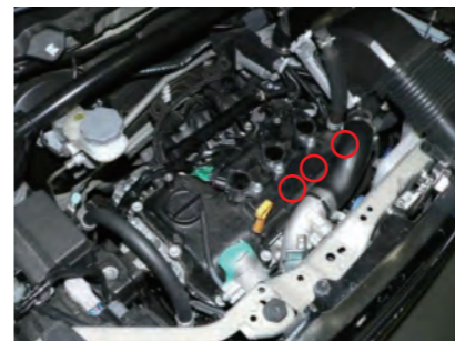
5. イグニッションコイルを固定しているボルトを外します。
