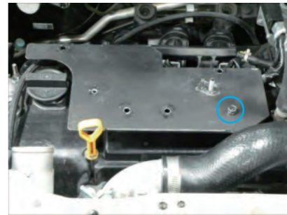
9. ビスDを使いヒートプレートの一箇所のみ固定します。スペーサーの落下に注意してください。
