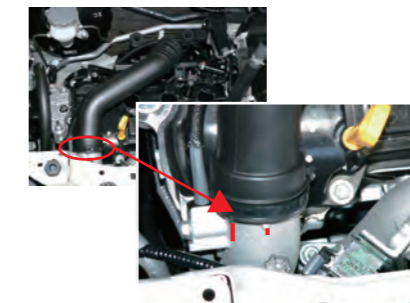
12. サクションホースを写真の角度でホースを固定します。
