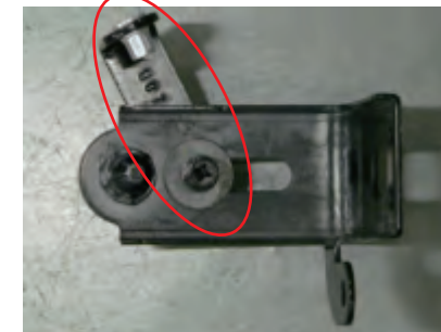
外した2つの純正ブラケットにステアを写真の角度でワッシャーを挟みビスAで取り付けます。
