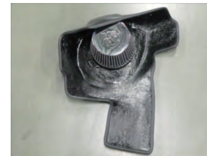
アダプターにフィルターを取り付けます。
