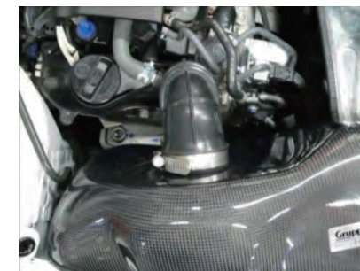
付属のホースバンドを使用しアダプターにサクシジョンホースを取り付けます。
