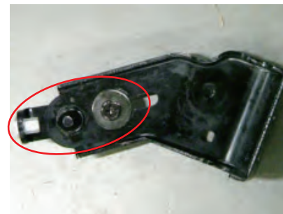
外した2つの純正ブラケットにステアを写真の角度でワッシャーを挟みビスAで取り付けます。
