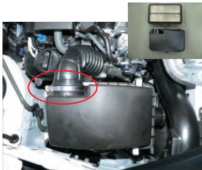
サクシジョンホースバンドを緩めてボックス上部とフィルターを外します。
