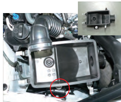
純正ビスを外してボックス下部を取り出します。
