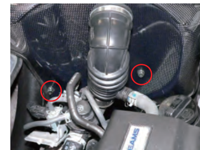
ビス A でカーボンケースを固定します。ビス孔が合わない場合は一度カーボンケースを外し、ステアを微調整してください。
