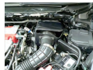
㉚フィルターケースASSYをエンジンルーム内に入れて配置します。
