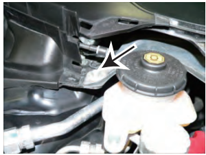
④アルミプレートの左右2箇所、中央のボルトを外して、アルミプレートを外します。
