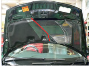
㉔両面テープで導入ダクトを貼り付け、付属のクリップで固定します。(赤線はカットの線です)
