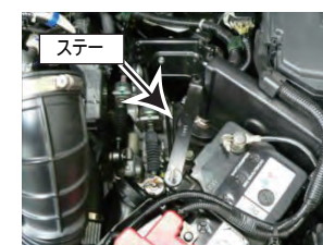
㉙写真のようにステーを仮組みします。フィルターケースを取り付ける為にステーをECU側に向けます。
