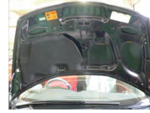
㉒カットしたインシュレーターフードをボンネットに取り付けます。中央・共締め、外側・ノーマルクリップ使用
