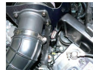
㉝エアマスセンサーのカプラーを取り付けます。
