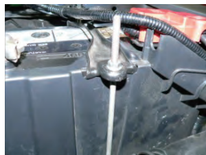
⑩バッテリー固定ブラケットのスタッドボルトにステーを取り付けます。
