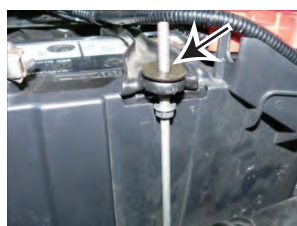
⑫スタッドボルトを元の通り配置して、ワッシャー、ステー、ロックナットの順で取り付けます。
