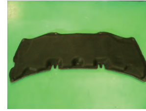
⑱インシュレーターフードにカーボン導入ダクトを取り付けるためにフードを加工します。
