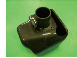
㉖その上にセンサーアダプターを乗せ、ビスで取り付けます。(必ずセンサーは下向きにします)
