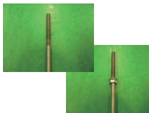
⑪スタッドボルトにノーマルのナットを逆さ向きに取り付けます。
