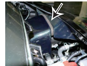
㉜一度ボンネットを閉めて、導入ダクトとフィルターケースの合わせを確認してステーを増し締め固定します。
