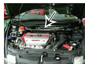
㉞アルミプレートを元に戻します。
