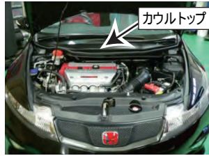
①一度カウルトップを外します。
