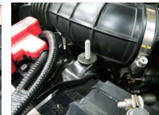
⑬写真のようにステーを取り付けます。バッテリーが固定されるまでねじ込んだら下側のナットを上までねじ上げてロックします。
