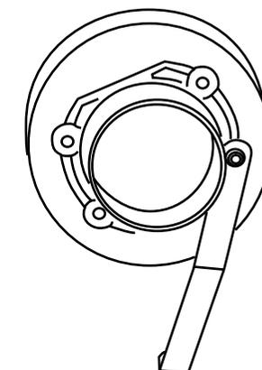
アースケーブルのボディ側を一度取り外し、装着後に元の位置に取り付けます。
