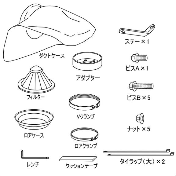
ダクトケース、フィルター、ロアケース、ロアクランプ、Vクランプ、アダプターは組み込まれた状態で梱包されています。
