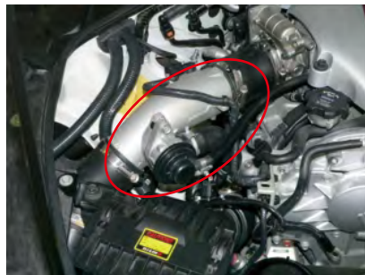
2.ホースバンドを緩めパイプをホースから外し、フリーな状態にします。(左右)
