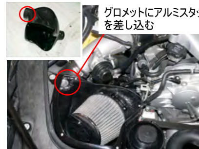
15.赤丸の導入孔をホースに差し込み、アルミスタッドをボディ側の純正グロメットに差し込むように車両に配置します。サクシオンホースバンドとセンサーカブラーを取り付けます。(左右)
