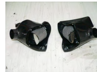
14.ファンネルアダプターにフィルターを取り付け、ホースバンドで固定します。センサーアダプターにセンサーをビスEx2で取り付けます。(左右)
