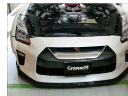
17.センサーカブラー・アース線・各部増し締めを行います。バンパーを取り付けて作業完了です。
