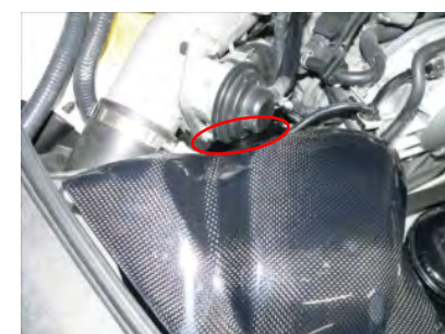
16.カーボンダクトをビスFx4で取り付けます。パイプとのクリアランスが少ない為、干渉する場合はパイプを回転させてください。(左右)
