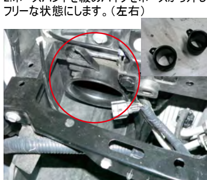
5.クリップを外し、純正導入ファンネルを外します。(左右)
