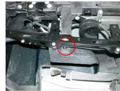
8.導入ダクトを車両に配置し外した純正ボルトで固定します。(左右)
