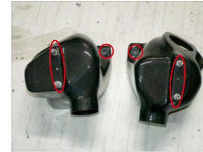
12.ビスB x4を使用してフィルターケースにアルミスタッドx4を取り付けます。グロメットx2も取り付けます。
