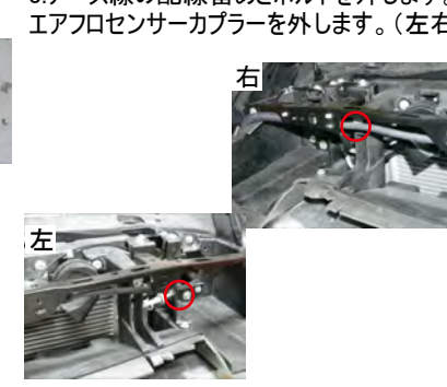
6.ボルトを外します。(左右)
