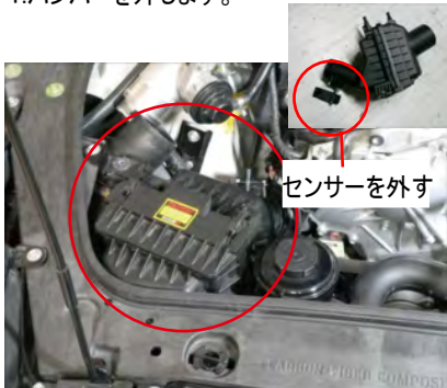
4.サクシオンホースバンドを緩め、ボルトを外してエアクリーナーボックスを外します。(左右)
