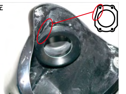
13.センサーアダプターとファンネルアダプターをフィルターケースにビスAを各4本使用して固定します。センサーアダプターはセンサーフランジ面が車両外側になるように固定してください。左側のファンネルアダプターはフランジ面が削られている方を上記写真の向きで取り付けてください。
