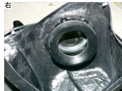
13.センサーアダプターとファンネルアダプターをフィルターケースにビスAを各4本使用して固定します。センサーアダプターはセンサーフランジ面が車両外側になるように固定してください。左側のファンネルアダプターはフランジ面が削られている方を上記写真の向きで取り付けてください。
