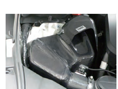
20. そのグロメットにカーボン ASSY のアルミスタッドがグロメットにしっかりと 3 箇所刺さるように配置します。
