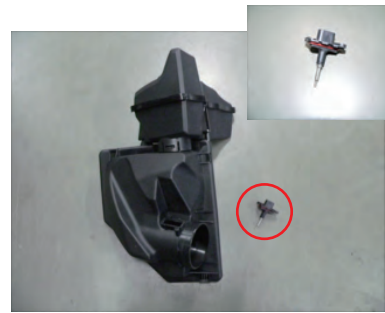
3. ボックス上部からセンサーを取り外します。
