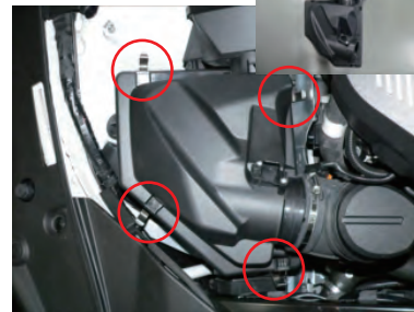
2. フックを4箇所外しクリーナーボックス上部を取り出します。
