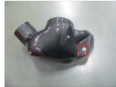
13. アルミスタッドをビス B を 1 本使用して固定します。必ず増し締めを行ってください。
