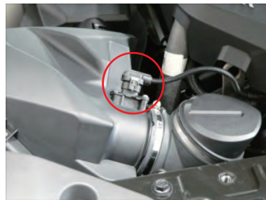
1. ホースバンドを緩め、センサーカブラーを外します。
