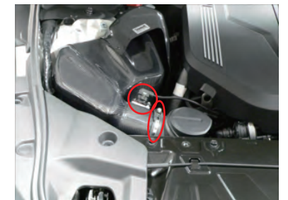
21. センサーカブラーを取り付けます。ホースバンドを締め込みます。
