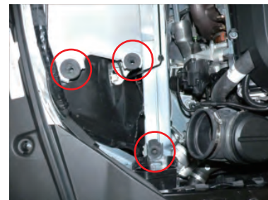
19. 車両側にグロメットが元の位置に付いているか再度確認します。
