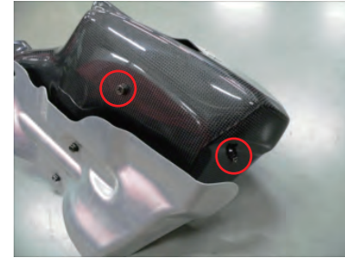
10. 15mmスペーサー 2 個を挟み、ビス C2 本でカーボンヒートプレートをナット 2 個を使用して固定します。
