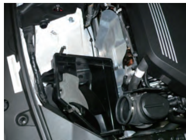
4. クリーナーボックス下部を上引き上げて取り外します。
