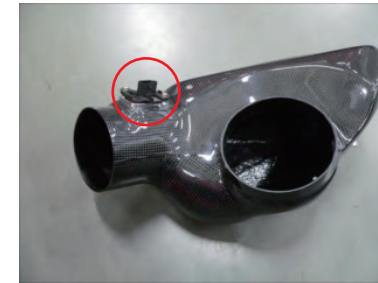
14. センサーと台座の間に M4 スペーサーを 2 個挟み、ビス D2 本でセンサーを固定します。
