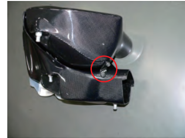
16. チャンバーケースとフィルターケースをビス A 1 本を使用して固定します。
