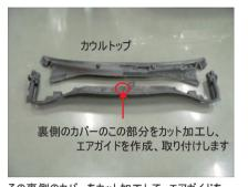
その裏側のカバーをカット加工して、エアガイドを 作成します。 ※この加工をする事でより効果的な外気導入が 可能となります。
