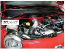
より効果的な外気導入を行うため、純正パーツを 加工してエアガイドを取り付けます。 ワイパー付け根部のカウルトップを外します。
