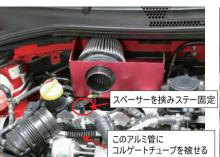
手前側のステー0083Bはアースボルト孔に共締め 固定。ステーの下に30mmスペーサーを挟んで固定 します。アルミ管に付属コルゲートチューブを被せます。
