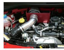
パイプのニップルにブローオフバルブホースを取付け、 ホースバンド#16で締め付けます。
