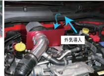
各部ホースバンドの締め付け、ステーの増し締め 固定を行います。 カウルトップの孔から外気を 効率よく導入します。
