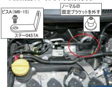
ノーマルの固定ブラケットの先端にレンチを差し 込み、ネジを緩ますように外します。(固いです) そこにステー0457AをビスA(M6-15)で取り付けます。
