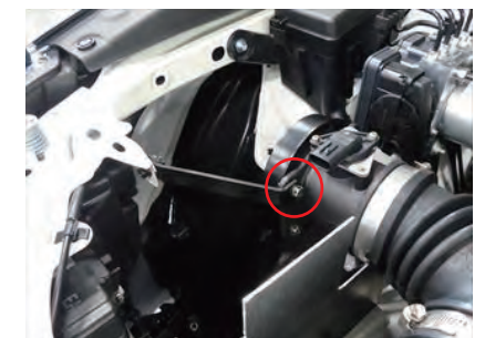
15. アダプター ASSY を純正サクシオンホースに取付けます。アダプター ASSY とステアをビス B で固定します。
