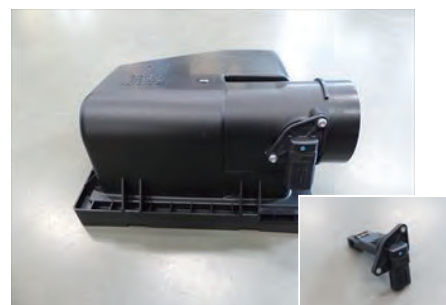
6. クリーナーボックスからエアフロセンサーを取外します。
