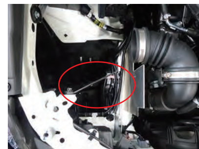
14. ステーをボディに取付けます。右の図の様に取付け、M6 ナットで固定します。
