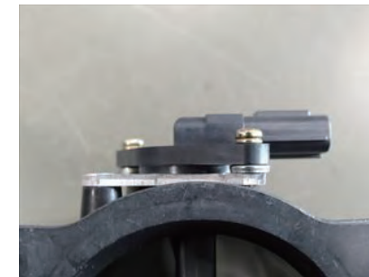
9. センサーアダプターとセンサーの間に M4 スペーサーx2 を挟み、ビス Dx2 で取付けます。
