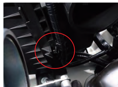
4. クリーナーボックスから配線留めを外します。
