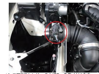
16. エアフロセンサーのカプラーを取付けます。
