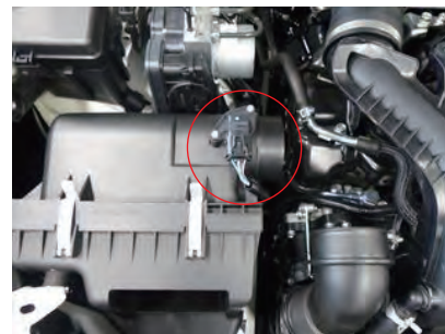
3. エアフロセンサーのカプラーを外します。
