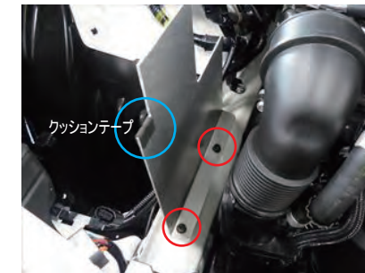
12. ビス A x2 でヒートプレートを固定します。ヒートプレートにクッションテープを適当な長さにカットして貼付けます。
