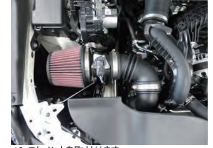
18. エレメントを取付けます。各部増し締めを行います。
