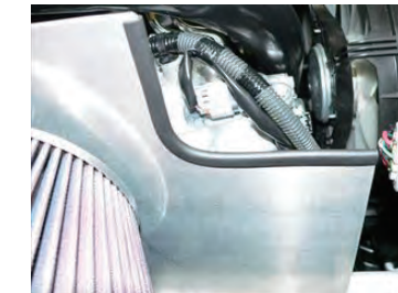
ヒートプレートに溝ゴムを市販のボンドなどで付けます。 (溝ゴムの上に導入ダクトが乗ります。)
