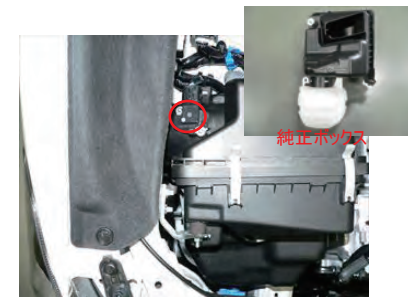
エアフロセンサーのカブラーを外しホースバンドを緩めボックスを取り外します。
