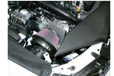
純正導入ダクトを取り付け、各部増し締め確認を行います。
