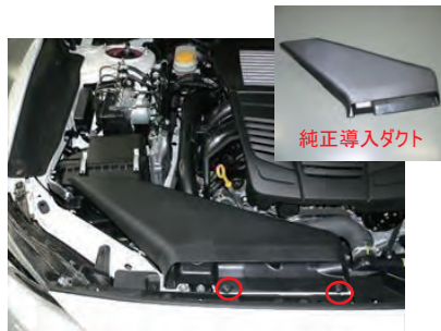
クリップを2箇所外し純正導入ダクトを取り外します。
