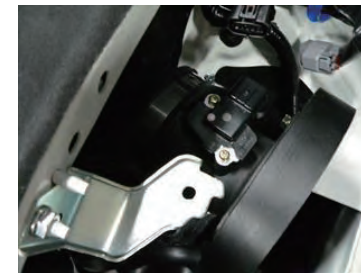
サクシジョンホースに組みたてたアダプターを取り付け、バンドで締付けます。 (ホースの直径に対しアダプター径が小さいですが、バンドで強く締め込んでください。)
