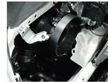
ステアとブラケットをビスAで取り付けます。エアフロセンサーカブラーを付けます。
