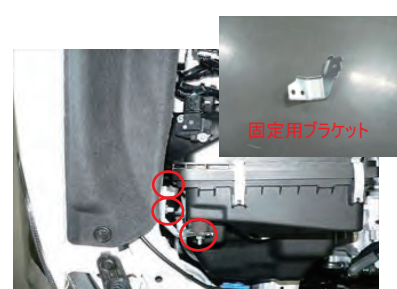
純正ボックスを固定してるブラケットを外します。ブラケットは取り付け時に使用します。
