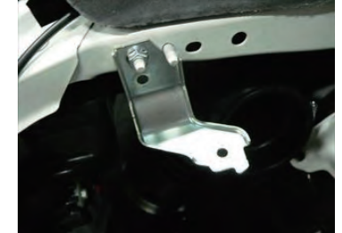
外したブラケットを反転させボディに純正ナットで取り付けます。
