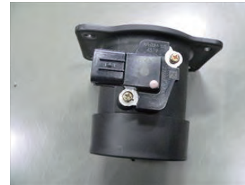
純正BOXからエアフロセンサーを外し、センサーアダプタにビスBで取り付けます。
