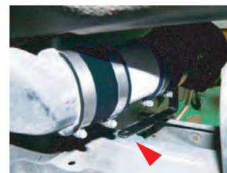
20. パイプを差し込み、バンドで固定します。その時、ステー孔とボディ固定孔の位置を合わせます。
