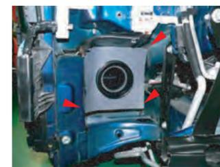
21. アダプターの位置調整をしながら良い位置でステーの角度を決めます。レインカバーシートが当たる所はハサミでカットします。
