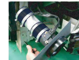
19. エアフロセンサーのカプラーを取り付け、アダプターASSYをインテークパイプに差し込みます。
