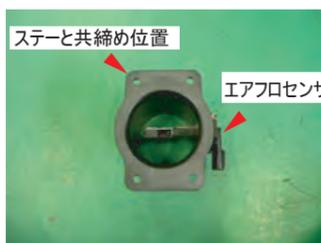
14. センサーアダプターにエアフロセンサーをビスDで取り付けます。
