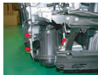
7. エアフロセンサーのカプラーを外します。次にタイヤハウス内からサクシオンバンドを緩め、3箇所のビスを外し、クリーナーケースを取り外します。ノーマルケースからエアフロセンサーを取り外します。(写真車両は2型)
