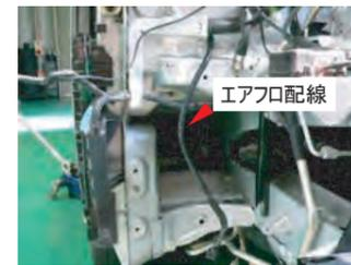
12. エアフロ配置に付属のコルゲートを巻き、タイラップで固定します。
