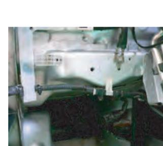
8. エアフロセンサーの配置が変わるため配線を取り出します。
