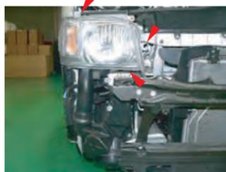
5. 右ヘッドライトを外します。(矢印部のビス、フックを外す)
