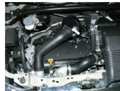
アダプター ASSY をサクシジョンホースに取り付けます。
