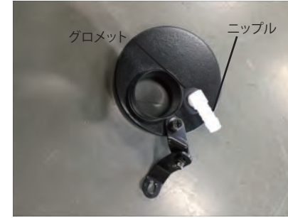
アダプターにステアをビス A で取り付け、グロメットとニップルも取り付けます。
