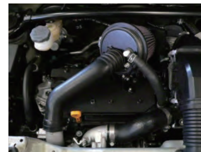
エレメントを取り付けます。フェューエルラインとタワーバーのクリアランスに注意してクリーナーの角度を調整してください。
