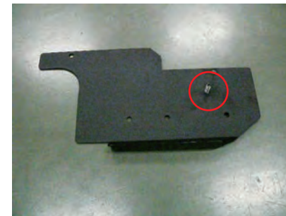
ヒートプレートの裏からビスE(トラスボルト)を取り付けます。
