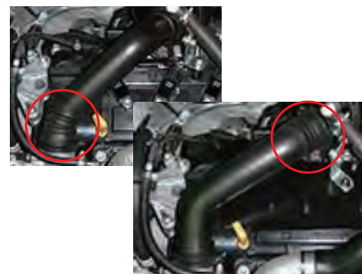
サクシジョンホースを反転させて取り付けます。(ジャバラの位置で確認してください)
