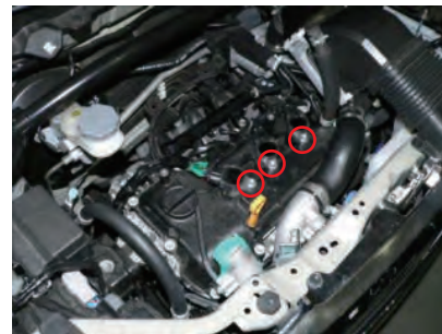
イグニッションコイルを固定しているボルト三箇所を外します。
