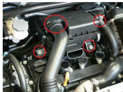
サクシジョンホースバンドを緩めます。ブローバイホースを抜きます。ボックス固定用のビスを外します。
