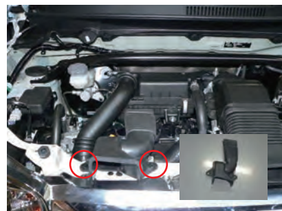
クリップを二箇所外し、導入ダクトを取り外します。
