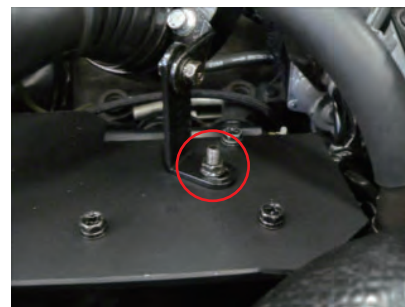
ステアをヒートプレート(ビスE部)にナットで固定します。
