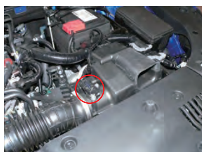
カバーを外さないでビスを2本外し、センサーを取り出します。
