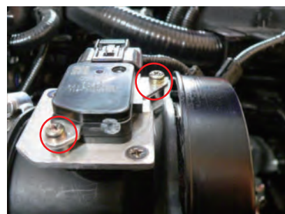
M4 スペーサーを挟みセンサーをビス C で取り付けます。
