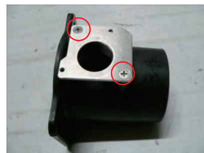
センサーアダプターに変換プレートを皿ビスで取り付けます。
