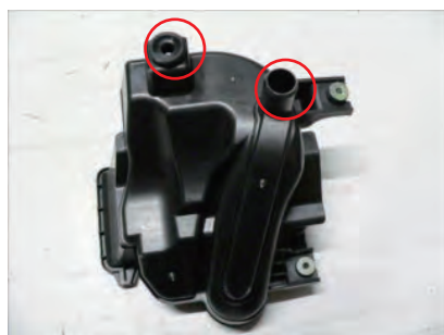
エアボックス下部を引き上げて外します。(グロメットと水抜き穴のゴムが固着して外しづらいです。)
