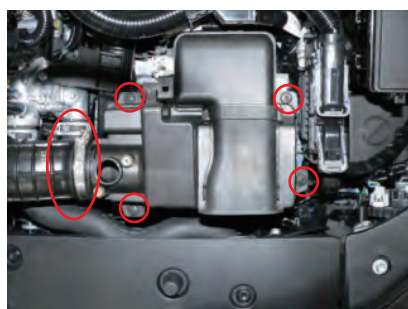
ホースバンドを緩めます。ビスを4箇所緩め、エアボックス上部を外します。
