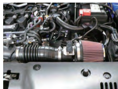
エレメントを取り付けます。ラジエーターホースとエレメントのクリアランスが少ない為、取り付けの際にエンジン側に寄せて取り付けてください。
