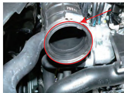
サクシジョンホースバンドを付属のホースバンドに付け替えます。
