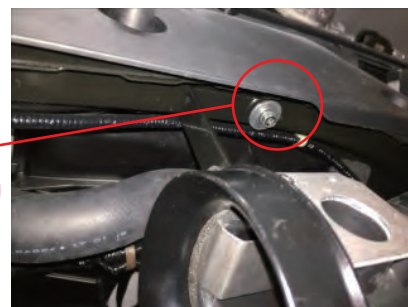
ボディとステアの固定は左図を参照して、固定します。
