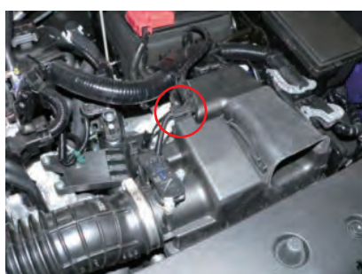
エアフロセンサーの配線留めを外します。
