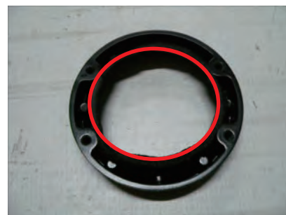
アダプターにパッキンテープを貼り付けます。
