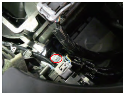
ECUの固定ボルトを外します。(エアボックスを取り出す際に少しECUを動かす場合がある為)
