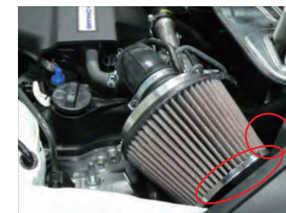
一度エレメントを付けて、ボディと干渉しない位置を決めます。
