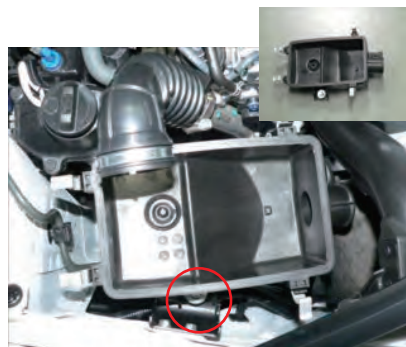
ボックス固定用ビスを外してボックス下部を取り出します。
