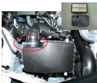
サククションバンドを緩めてボックス上部とフィルターを外します。
