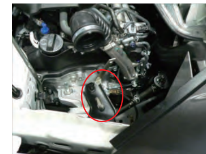
ブラケットの長穴にステアをビスAとナットを使用し仮組みします。(ステアはブラケットの下側)
