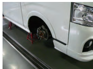
リジットトラックを使用して右前タイヤを外します。
