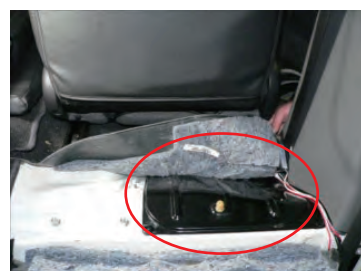
運転席後ろのカーペットをめくり、エンジンカバーを外します。
