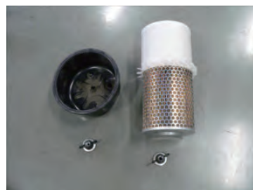
センターのネジを外して、フィルターを取り外します。
