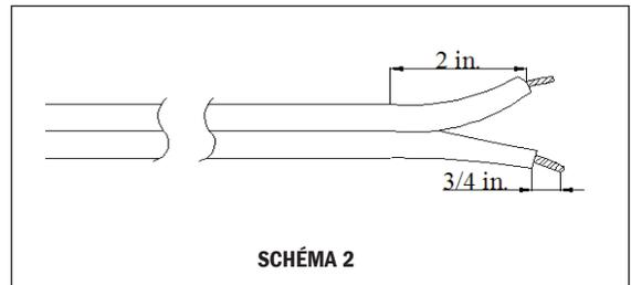
REMARQUE: Utilisation du câble de calibre correct est essentiel pour obtenir un bon rendement de l'éclairage. Pour l'usage avec SPT-3, SPT-2W, souterrain bas circuit d'énergie câble de type extérieur (Longueur 25 minimum).
