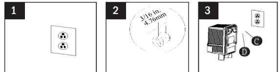
REMARQUE : Ne pas fixer le transformateur au mur à ce moment. Tout d'abord, connectez le câble a basse tension aux bornes du transformateur.
