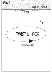
4) TWIST THE PUCKLIGHT TO LOCK IT TO THE SOCKET
