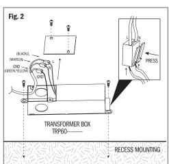
2) CONNECT 120V AC CABLE TO LUMINIZ TRANSFORMER BOX BY USING THE QUICK CONNECTORS.
