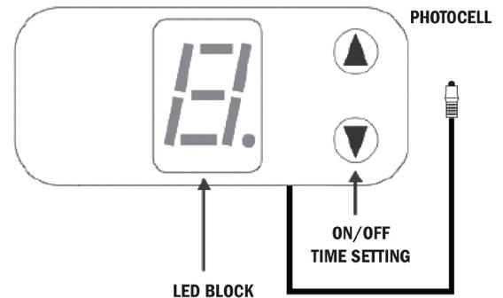
La cellule photoélectrique fonctionne avec un retard léger pour éviter les fausses réactions aux changements momentanés dans des conditions de lumière ambiante, tels que des phares de voiture.
