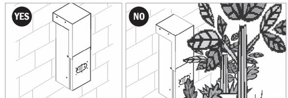
Gardez transformateur libre de toute obstruction. Cela permettra d'éviter la cellule photoélectrique d'allumer le système prématurément.
