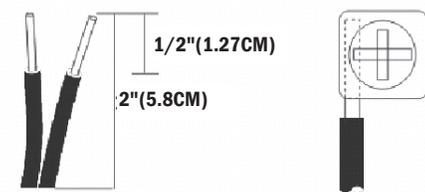
**Positionnez 1 fil sous chaque plaque de pression de la borne et serrez la vis en toute sécurité. Assurez-vous que l'isolant des fils ne touche pas la plaque de pression.**
