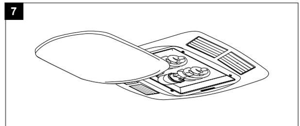
8. Pincez les ressorts de fixation sur la grille et insérez-les dans les étroites fentes rectangulaires à l'intérieur du boîtier du ventilateur, à côté du moteur du ventilateur.
